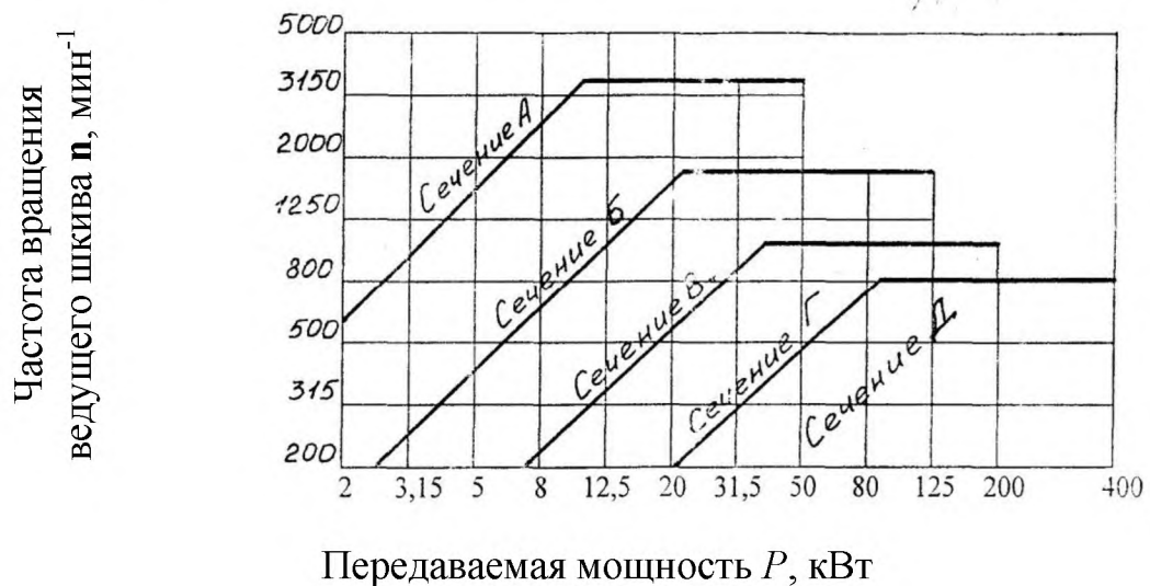
Рис. 3.1.3 Номограмма для выбора сечения клинового ремня рассчитываемой передачи
